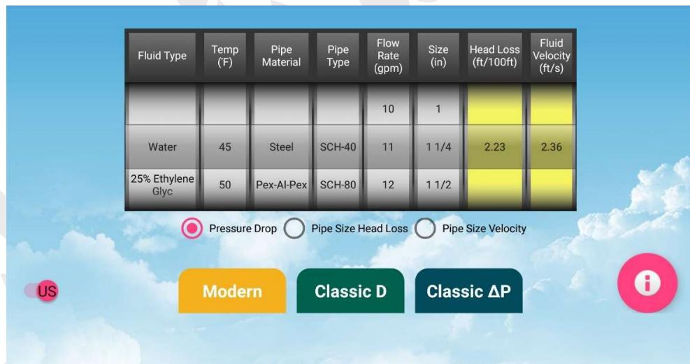
در شکل بالا درصورتی که سایز را روی ۱ اینچ قرار دهیم مقدار نرخ افت فشار برابر  $\frac{8}{66}$  میشود و در صورتیکه روی  $\frac{1}{2}$  ۱ اینچ قرار دهیم نرخ افت  $\frac{1}{73}$  و سرعت  $\frac{1}{105}$  میشود بنابراین سایز  $\frac{1}{4}$  بهینه‌ترین حالت است.
