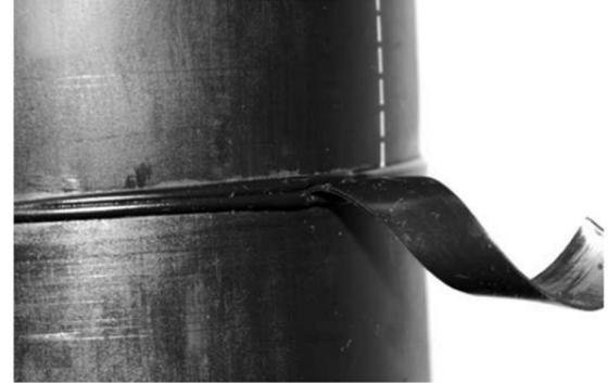
شکل سمت راست، وضعیت ظاهری غیرقابل پذیرش جوش لب به لب و پلیسه در محل اتصال و شکل سمت چپ وضعیت ظاهری قابل پذیرش جوش لب به لب و برگدان مناسب لبه
